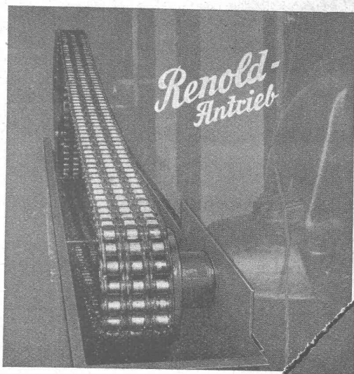
eines „Holländers“, 150 PS, bei 435/1116 T. p. M.
