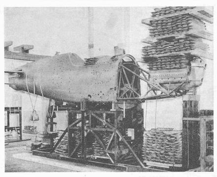
Bild 10. Rumpfbelastung im Falle «Abfangen aus dem Sturzflug» mit  $f = 1,25~(14~{\rm t~Blei})$
