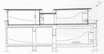
Bild 2. Querschnitt 1:300 der Aufstockung, mit Tageslichtkurven
