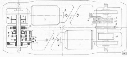
Bild 14. Drehgestell der BCFhe 4/4-Triebwagen, Serie 301, der Berner Oberland-Bahnen für gemischten Zahnstangen- und Adhäsionsbetrieb (kombinierter Antrieb) 1 Motor, 2 Rutschkupplung, 3 Kardanwelle, 4 erste Uebersetzung (Kegelradgetriebe). 5 zweite Uebersetzung (Stirnradgetriebe) zum Antrieb der Adhäsionsachse 7, 6 zweite
