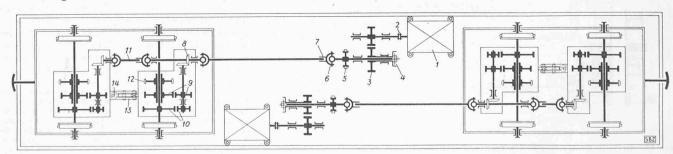
Bild 15. Antriebsanordnung für gemischten Zahnstangen- und Adhäsionsbetrieb (kombinierter Antrieb) der BCFhe 4/4-Triebwagen, Serie 1. der Elektrischen Bahn St. Gallen-Gais-Appenzell.
