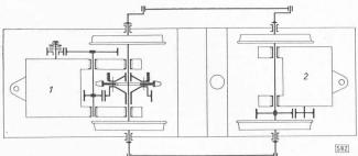
Bild 18. Drehgestell der BCFhe 4/4-Triebwagen, Serie 1, der Bahn Aigle-Ollon-Monthey-Champéry für gemischten Zahnstangen- und Adhäsionsbetrieb und getrennten Triebwerken. 1 Zahnstangenmotor, 2 Adhäsionsmotor
