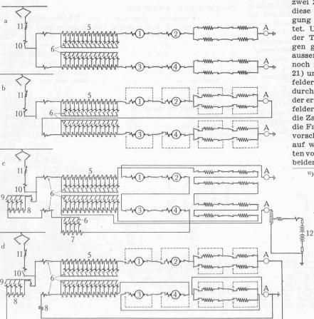
Bild 21. Schaltung der Triebmotoren der BCFhe 4/4-Triebwagen, Serie 1, der Elektrischen Bahn St. Gallen-Gais-Appenzell. I Fahrt mit vollen und geschwächten Feldern, II Fahrt mit übererregten Feldern, III Schaltung für elektrische Bremsung (Widerstandsbremsung)
