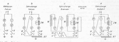
Bild 25. Schaltung der Adhäsions- und Zahnstangenmotoren der Fhe 4/6-Gepäcktriebwagen, Serie 901, für die Brünigstrecke der SBB.
