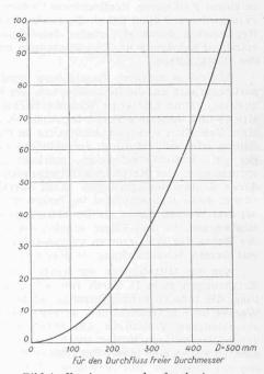
Bild 4. Verringerung der durch eine Leitung von 500 mm 1. W. durchlaufenden Wassermenge in % infolge Abnahme des freien Durchmessers durch Ablagerungen im Rohrinnern
