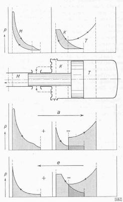
Bild 4. Kolbenkraft-Diagramme für Auswärts- und Einwärtshub.
