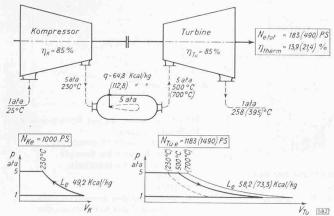
Bild 1. Schema eines offenen Gasturbinen-Prozesses
