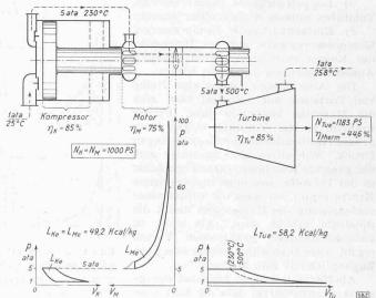
Bild 2. Schema eines Freikolbengenerator-Prozesses mit Gasturbine
