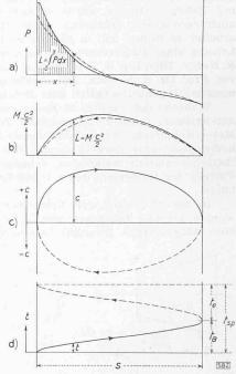
Bild 5. Diagramme zur Dynamik der Kolbenbewegung.
