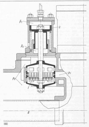
Bild 19. Stabilisator.  $p_S$  momentaner Druck im Spülluft-Sammler,  $\overline{p}_S$  mittlerer Spülluftdruck,  $p_T$  momentaner Druck in der Totstufe,  $\overline{p}_T$  mittlerer Totstufendruck. 1 Plattenventil, 2 Druckkolben, 8 Führungsrohr Masstab 1:5
