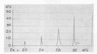
Bild 16. Motor-Kompressionsdiagramme für verschiedene Anlassdrücke  $p_{A}$
