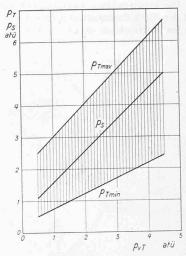
Bild 17. Druckbereich in der Totstufe und Druck im Spülluftsammler in Funktion des Betriebsdruckes.
