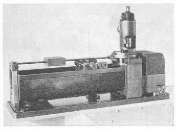
Bild 44. Waagenelement mit abgehobener Verschalung
