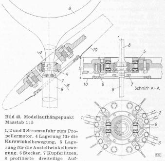
hängestrebe, 9 profilierter Vorspannungsstab mit eingebauten Stromleitern, 10 Modell
