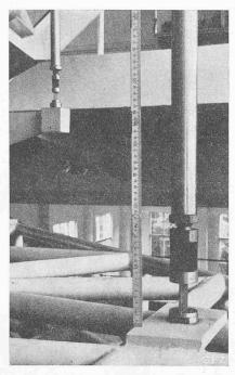
Bild 34. Bandgelenke, links für 250 kg Zugbelastung, rechts für 3500 kg
