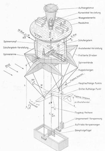
Bild 32. Genereller Aufbau einer Mehrkomponenten-Waage mit den Bezeichnungen der Einzelteile
