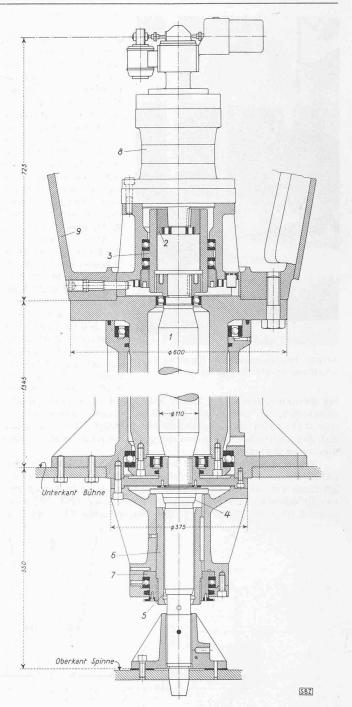
Bild 37. Zentrale Blockierung der Spinne, Masstab 1:8
