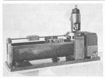
Bild 44. Waagenelement mit abgehobener Verschalung
