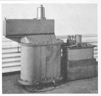
Bild 45. Staudruckwaage, unten Behälter für die zwei Glocken
