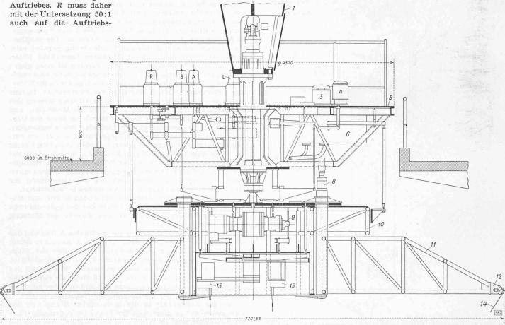
Bild 35. Achtkomponenten-Waage des grossen Windkanals, Schnitt quer zum Wind, Masstab 1:40
