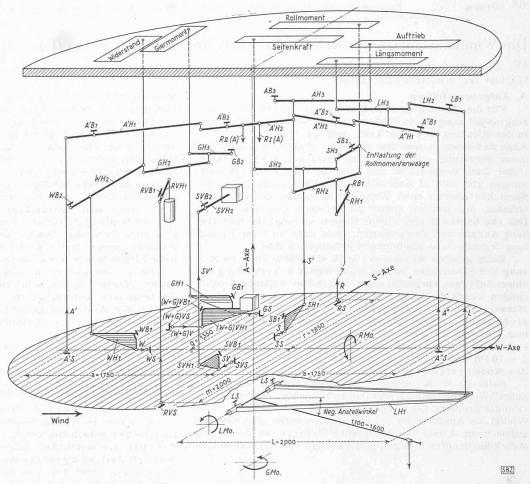
Bild 33. Prinzipschema des Uebertragungsmechanismus des grossen Windkanals
