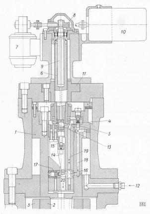
Bild 39. Servomotor und Steuerung zur Kurswinkel-Verstellung Masstab 1:5
