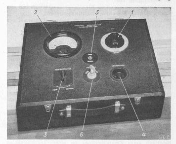
Bild 19. Tragbarer Steuerkasten für den Gebläseantrieb. 1 Drehzahleinsteller, 2 Stellungsfernanzeiger der Feineinstellung, 3 Feineinsteller «Mehr - 0 - Weniger», 4 Notknopf, 5 Umschalter «Hand» - «automatisch», 6 Sicherheitsschlüssel
