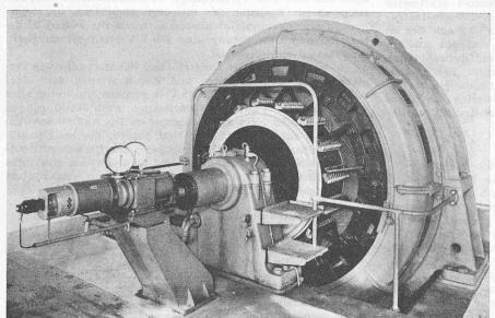
Bild 25. Betriebsmotor des grossen Gebläses mit angebautem Reguliergetriebe, Kontrolltachometern und Steuerfrequenzgenerator
