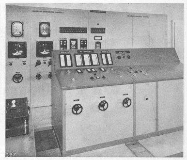
Bild 28. Schalttafel für die Hilfsantriebe des grossen Windkanals in der Messhalle. Die aufgemalten Symbole bedeuten die verstellbaren Objekte und zeigen ihre Bewegungsrichtung an raum
