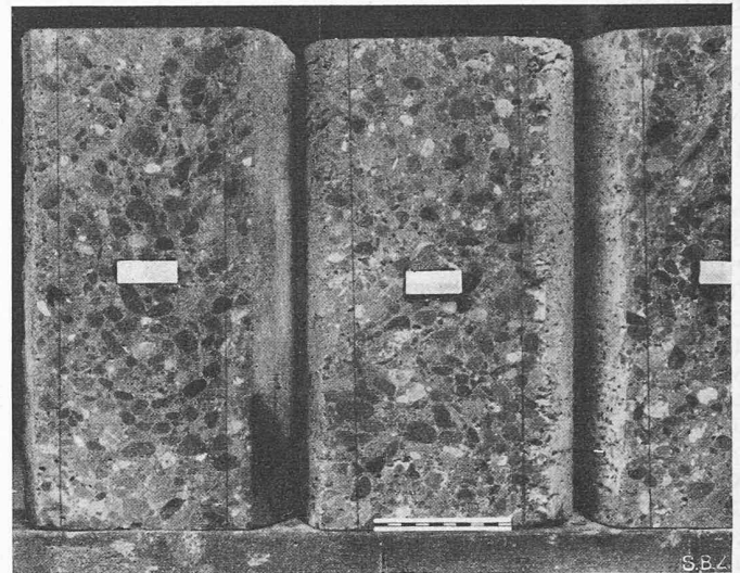
Bild 3. Rohrbeton-Schliffe zeigen gute Verteilung der Zuschlagstoffe
