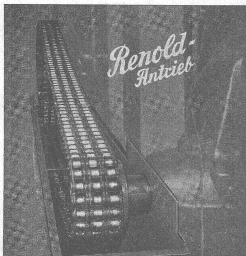
eines „Holländers“, 150 PS, bei 435/116 T.p.M.
