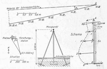
Bild 11. Wahre Verschiebung eines Punktes der Firnoberfläche [13]
