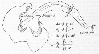
Bild 18. Näherungsweise Bestimmung der verhältnismässigen Zunahme  $\alpha$  des jährlichen Wasserabflusses infolge Ablation zwischen Firnlinie und Gletschertor.  $\beta$  = Proportionalitätsfaktor, y = Höhendifferenz zwischen Firnlinie und Element  $\Delta F$
