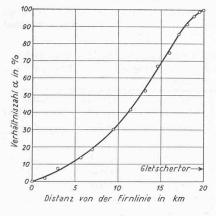
Bild 20. Ungefähre prozentuale Zunahme α des jährlichen Wasserabflusses des grossen Aletschgletschers infolge Ablation zwischen Firnlinie u. Gletschertor, in Funktion der Meereshöhe der Gletscheroberfläche
