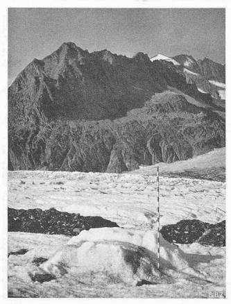
Bild 14. Schutzwirkung eines Zeltes gegen die Ablation beim Konkordiaprofil (10 Tage). Photo F. Denzler, 3. Sept. 1947
