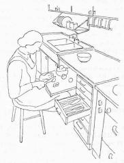
Bild 4. Der Arbeitstisch mit zwei verschieden hohen Arbeitsflächen — eine für stehendes Arbeiten und eine zum Arbeiten in sitzender Stellung
