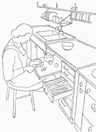
Bild 4. Der Arbeitstisch mit zwei verschiedenen hohen Arbeitsflächen — eine für stehendes Arbeiten und eine zum Arbeiten in sitzender Stellung
