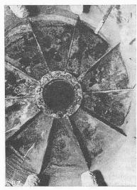
Bild 9. Trommel-Wärmeaustauscher mit Hubschaufeln (aussen) und Leitschaufeln für die Luftströmung an
