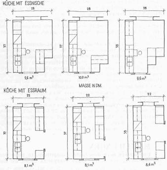
Bild 5. Anwendung des Standardvorschlages auf einige Küchengrundrisse
