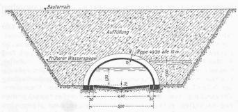
Bild 14. Eindeckung eines Kanals, 1:200
