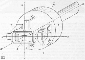
Bild 1. I Kreiselrotor, A Aufhängung, F Feder, R Reibungsdämpfer,  $I_1$  Torsionsmasse, X-X Wellenaxe, Y-Y Aufhängungsaxe, Z-Z Kreiselrotoraxe
