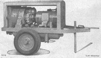
Zweiradaggregat mit Luftkühlung und Elektromotorantrieb, 4,6 m<sup>8</sup>/min. eff.
