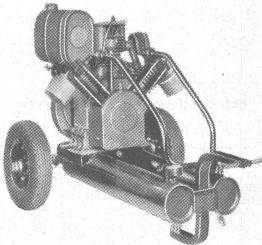
3 verschiedene Modelle für Pressluftwerkzeuge und Sandstrahlgebläse, Stein- und Bildhauerarbeiten, Dübel- und allgemeine Maurerarbeiten und zum Spritzen von Farben und Emulsionen (Teer und andere Imprägnierungsmittel)
