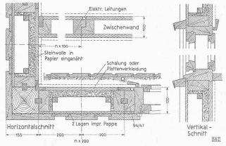
Bild 2. Einzelheiten der Konstruktion, Masstab 1:12
