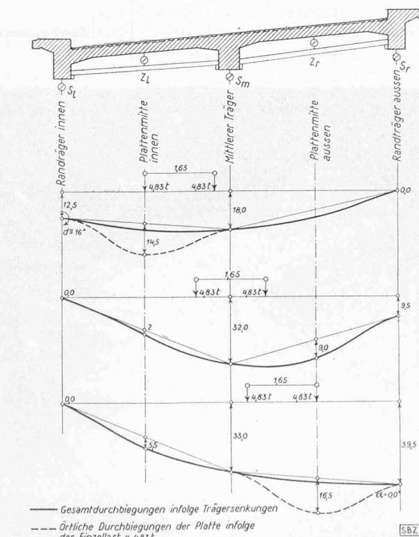
Bild 9. Marchgrabenbrücke. Querdurchbiegungen der Brücke in der Mitte der Öffnung 3 (Ordinatenmasstab wie Bild 8)
