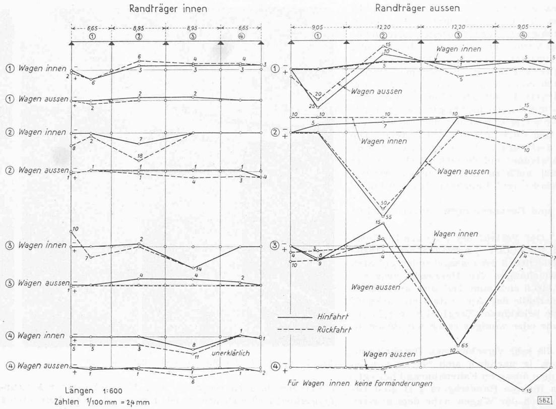
Bild 8. Schematische Aufzeichnung der Durchbiegungen aller Öffnungsmitten; Summeneinflusslinien
