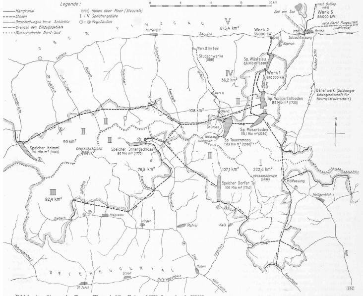
Bild 1. Ausnützung der Tauern-Wasserkräfte, Entwurf 1938, Lageplan 1:300000
