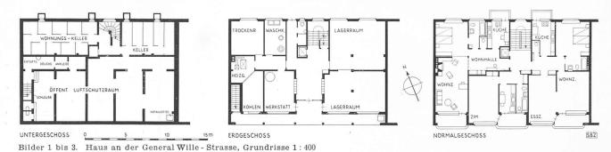
boden auf rd. 2,30 m Höhe über Trottoir gehoben, wodurch man ein Untergeschoss mit Säulen-Vorhalle gewann. Die keramische Verkleidung der Säulen wurde erst nachträglich, nachdem diese bereits in Sichtbeton ausgeführt waren, bestimmt. Der zweite Keller diente — und wird vielleicht wieder dienen - als öffentlicher Schutzraum. Konstruktion Eisenbeton (einschl. Fundamentplatte in der Seekreide). Baujahr 1941/42. Rauminhalt 5000 m3, Baukosten 78 Fr./m3.
