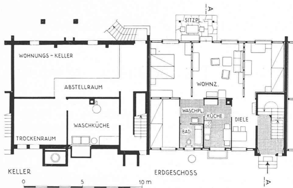
Bild 7. Grundrisse und Schnitt der Zweifamilienhäuser im «Schachen»; Masstab 1:300
