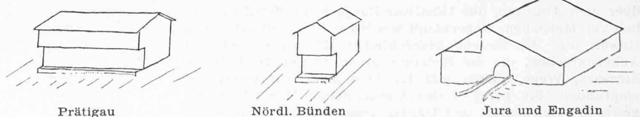
Bild 7. Typenschema von Scheunen mit und ohne Hocheinfahrt. Unsere Stallscheunen sind nicht weniger sorgfältig auf den Landschaftsraum bezogen, als es die Wohnhäuser sind. Ihre Bauformenveränderung gleicht derjenigen des Wohnhauses, indem auch hier vom Mittelland zu den Alpen der Wechsel vom trauf- zum giebelständigen Baukörper festzustellen ist. Ebenso wie vom Haus in den Bergen zwei- oder dreiseitig umlaufende Lauben nicht wegzudenken sind, so wendet sich die Stallscheuer an den Hängen mit frei vorkragendem oder pfostengestütztem Heuboden, unter dem die Stalleingänge liegen, gegen das Tal. Die Scheune in der Ebene nimmt hingegen durch ihre Geschlossenheit Bezug auf die andersgeartete, in sich ruhende Landschaft und gleicht dadurch wiederum dem Wohnhaus.
