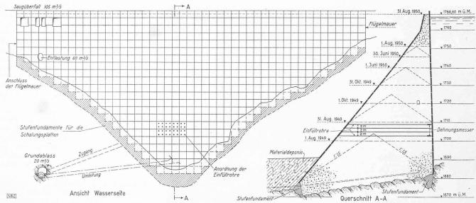
Bild 1. Ansicht des Mittelteils der Rätherichsboden-Staumauer von der Wasserseite und Querschnitt, Masstab 1:1400
