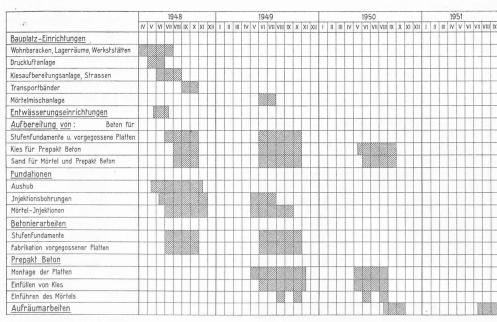
Bild 4. Bauprogramm für die Staumauer Rhäterichsboden, Projekt in Prepakt-Beton
