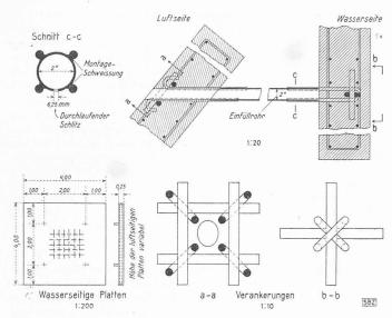
Bild 3. Einzelheiten der Platten und Einfüllrohre
