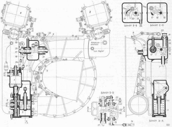
Bild 7. Ladedruckregler und Kommandogerät, Masstab 1:5
