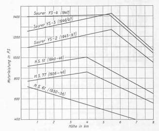
Bild 9. Höhenverhalten verschiedener Flugmotortypen
