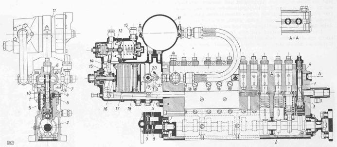
Bild 6. Benzin-Einspritzpumpe mit Gemisch-Regler, Masstab 1:4
