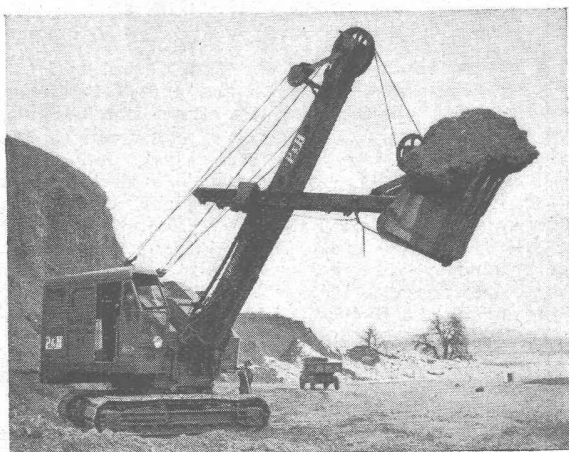
Löffelbagger mit Tru-Lay-Brugg-Drahtseilen ausgerüstet
