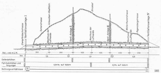
Bild 2. Längenprofil des Milchbucktunnels. Längen 1:25000, Höhen 1:2500
