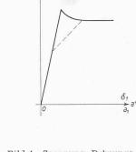
Bild 3. Spannung-Dehnungsdiagramm für den einfachen Zugversuch der Spannungen  $\sigma_e$  und  $\sigma_f$  an der ersten und zweiten Fliessgrenze, sowie der bleibenden Dehnung  $a^*$  an der zweiten
