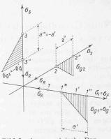
Bild 2. Axonometrische Darstellung der Teilchen 1", 2', 3" in den Seitenflächen des Einheitswürfels und der Gitterspannungen  $\sigma_{g_1}$ ,  $\sigma_{g_2}$ ,  $\sigma_{g_3}$  nach einem einseititigen Fliessen in Richtung 1 an der zweiten Fliessgrenze  $\sigma_1 = \sigma_f \text{ entsprechend } \sigma_{g_1} = \sigma_{g'},$
