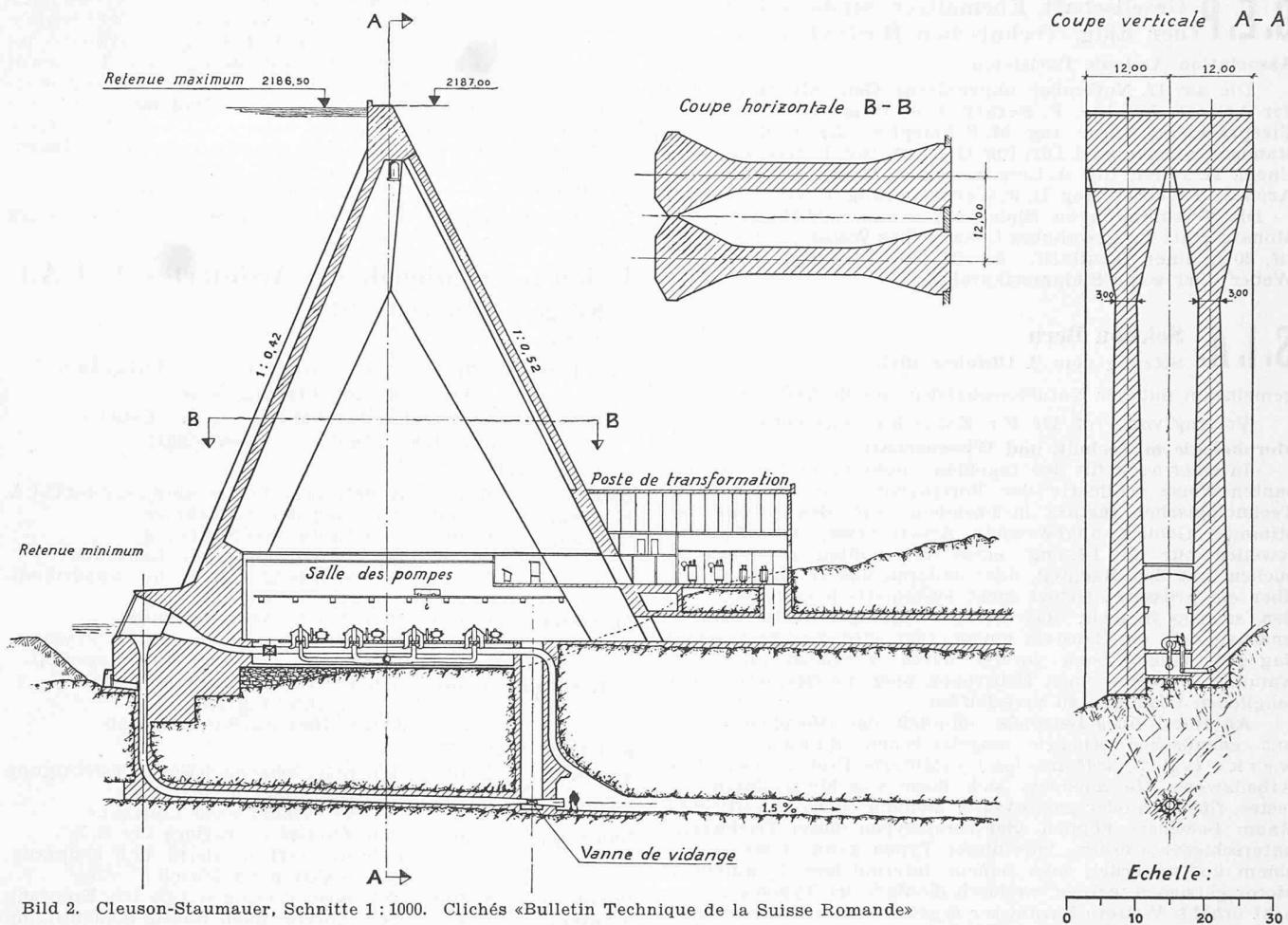
Bild 2. Cleuson-Staumauer, Schnitte 1:1000. Clichés «Bulletin Technique de la Suisse Romande»
