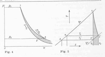
diagramme (p, v) et représentative de  $L_f$  est celle hachurée horizontalement aussi et délimitée par la ligne de transformation (1,2) et les lignes isentropiques  $s_1$  et  $s_2$  des points 1 et 2. Pour la détente (1,2) réelle le travail moteur  $L_m$  s'obtient maintenant par les formules:
