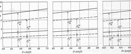
Bild 19. Statische Richtkräfte  $P_r$  und dynamische Richtkräfte  $P_m$
