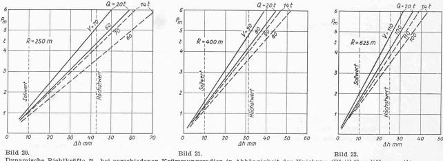
Dynamische Richtkräfte  $P_m$  bei verschiedenen Krümmungsradien in Abhängigkeit der Knickung (Pfeilhöhendifferenz  $\varDelta h$ )
