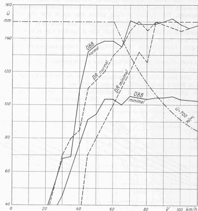
Bild 2. Bei der Deutschen Reichsbahn und den Oesterreichischen Bundesbahnen übliche Ueberhöhungen in Abhängigkeit der Fahrgeschwindigkeit
