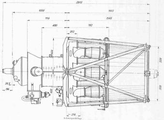
Bild 11. Propeller-Turbo-Triebwerk «Theseus» von Bristol
