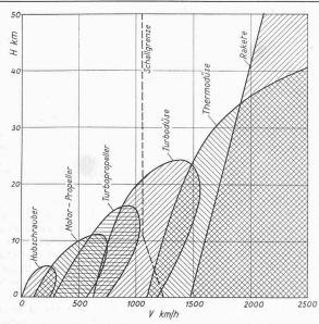
Bild 16. Geschwindigkeits- und Höhenbereiche für die verschiedenen Flugzeugantrieb-Systeme
