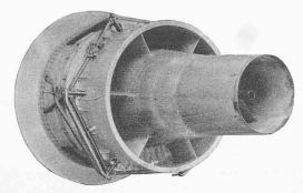
Bild 9. Heckansicht des Doppelstrom-Düsen-Triebwerkes «Metrovick F3» mit der koaxialen Ringöffnung des Schubvermehrers
