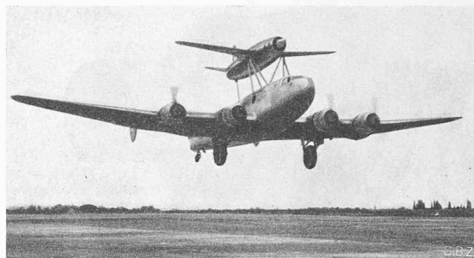
Bild 13. Flugzeug «Leduc 010» mit Thermo-Düsenantrieb. Versuchsflug mit einem viermotorigen Mutterflugzeug «Languedoc»
