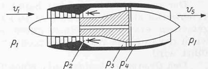
Bild 1. Zum Prinzip des Turbo-Düsen-Triebwerkes.  $V_1$  Fluggeschwindigkeit,  $V_5$  Ausströmgeschwindigkeit,  $p_1$  Aussendruck,  $p_2$  Druck nach Kompressor,  $p_3$  Druck nach Brennkammer,  $p_4$  Druck nach Turbine,  $p_5$  Druck nach Düse = Aussendruck  $p_1$
