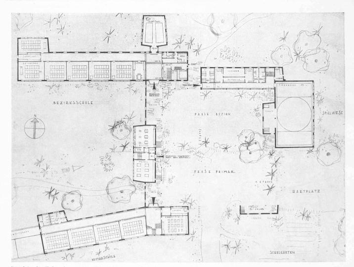
Grundriss der Erdgeschosse, oben Südansicht der Bezirkschule und Schnitt durch Turnhalle. Masstab 1:700
