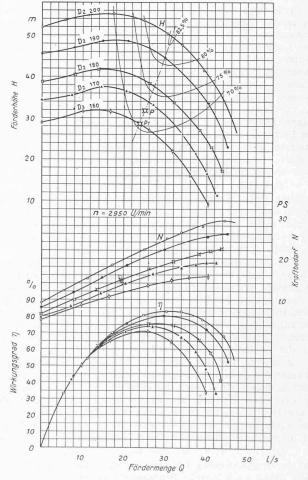
Bild 5. Versuchsergebnisse über das Zurückdrehen eines Pumpenlaufrades  $D_2\!=\!200\,\mathrm{mm}$ um je 10 mm. Leistungsverminderung bei  $D_2\!=\!160\,\mathrm{mm}$ : nach Rechnung:  $P_1$  nach Versuch:  $P_1$
