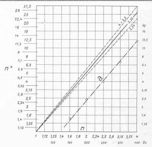
Bild 11. Gewichtsänderung modellähnlicher Maschinen oder Maschinenteile. a bei n-facher Vergrösserung ist x=2,36 und gilt für Pumpenlaufräder der Bauform c, Bild 9
