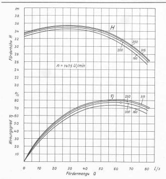
Bild 10. Vergleichsversuche modellähnlicher Pumpen. Q und H umgerechnet auf Laufraddurchmesser  $D_2=315\,\mathrm{mm}$
