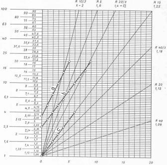
Bild 2. Auffinden von Normzahlreihen auf halblogarithmischem a) spezifische Drehzahl ns Reihe 20/3, b) Stutzenweite Reihe 10, c) Laufraddurchmesser von Kreiselpumpen Reihe 10
