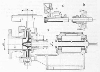
Bild 14. Genormte, einstufige Niederdruckpumpe, Bauart Pumpenbau Brugg. a) Normalausführung, b) mit Gleitlager bei gleicher Welle, c) Kühlringausführung für Temperaturen über 115°C
