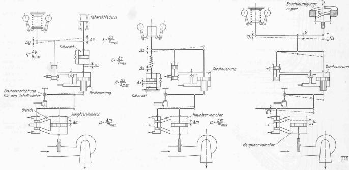
Bild 4. Drehzahlregler mit Rückführkatarakt. Die Vorsteuerung wirkt praktisch ohne Zeitverzögerung. Die Abweichung  $A_x$  des Kataraktkolbens ist also in jedem Augenblick so gross wie die Reglerabweichung  $A_y$ . Der Hauptservomotor kann der Vorsteuerung beliebig schnell folgen, da der Katarakt die zur Stabilität notwendige Verlangsamung der Reglung sichert. Der Schaltwärter kann ohne Verlangsamung durch den Katarakt direkt den schnellwirkenden Hauptservomotor verstellen.
