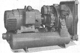
Luftgekühlter Baukompressor 4,5 m³ pro Min.
