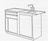
Bild 29. Spültisch-Einheit zur Küche von Bild 4. Unter dem Tropfbrett Besteckschublade. Masse: 130 × 60 × 85 cm
