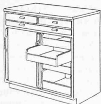
Bild 30. Rüsttisch-Einheit HSB-BORO. Links feste Tablare, rechts Ausziehfächer. Unter den oberen Schubladen Ausziehbrett. Masse: Länge 75, 90, 105, 120 cm; Höhe 80 u. 90 cm; Tiefe 57 cm
