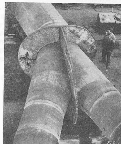
Bild 14. Verteilrohr am untern Ende der Druckleitung mit Kragenverstärkung, Werkaufnahme
