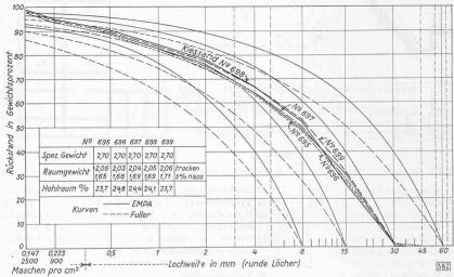
Bild 9. Siebkurven verschiedener Kiessande aus dem Werk Littau
