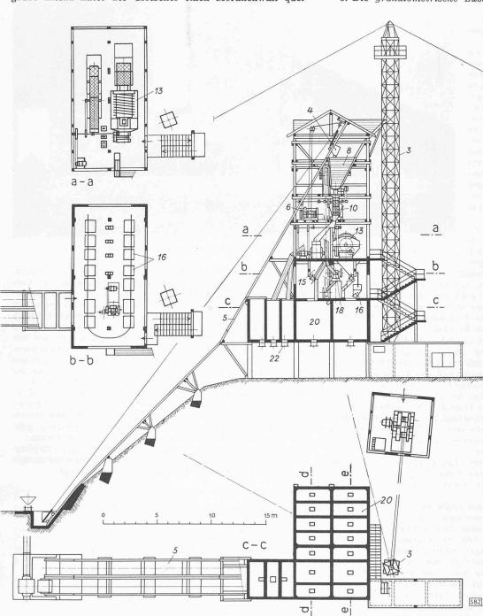
Bild 7. Kiessand-Anlage Littau. Grundrisse und Schnitt durch den Kübelaufzug. — Masstab 1:300
