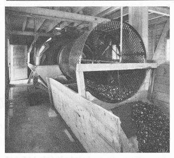
Bild 15. Trogwaschmaschine; Unterwassersortierung (13) und Aussensortierung (14)
