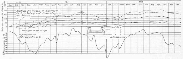
Bild 29. Ausgeglichene Kurven der Betonspannungen (berechnet mit  $E_b = 200\,000$  kg/cm³, m = 5) und der mittleren Luftt $\epsilon$ mperatur
