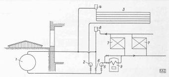
Bild 1. Schema der ausgeführten Versuchsanlage. 1 Speicher mit Dach in der Nähe des Gebäudes, 2 Umwälzpumpe, 3 Aufnehmer, 4 Expansionsgefäss, 5 Heizwasserpumpe, 6 Rücklaufbeimischung, 7 Heizkörper, 8 Expansionsgefäss der Zentralheizung, 9 bestehender Heizkessel
