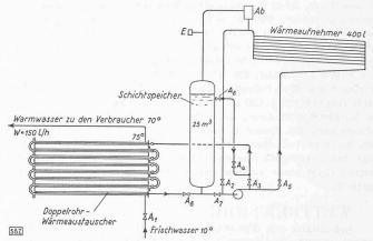
Bild 3. Vorgesehene Warmwasserbereitungsanlage
