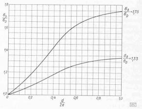
Bild 2. Werte  $\sigma_b/\sigma_D$  in Abhängigkeit von d/2e
