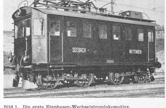
Bild 1. Die erste Einphasen-Wechselstromlokomotive, gebaut 1905 von der Maschinenfabrik Oerlikon, Leistung  $2\times 250\,\mathrm{PS}$
