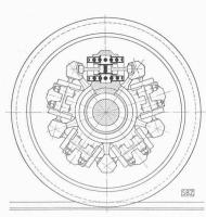
Bild 5. Federantrieb von Sécheron mit Stösseln
