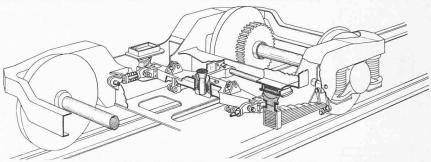
Bild 10. Triebdrehgestell der Fø4/4-Triebwagen, geliefert 1938/39 von der SLM ursprünglich an die SBB
