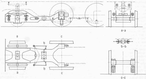
Bild 8. Prinzip der Abfederung beim Java-Drehgestell, Masstab 1:60
