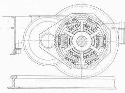
Bild 6. Federantrieb von Brown Boveri, im grossen Zahnrad eingebaut
