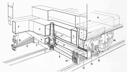
Bild 11. Triebdrehgestell der SLM, erstmals gebaut 1944 für die B<sub>0</sub>'-B<sub>0</sub>'-Lokomotiven der BLS
