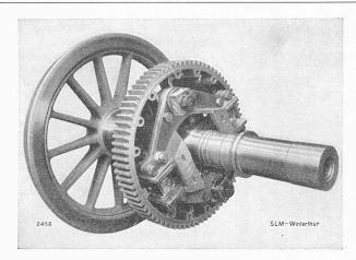
Bild 4. Kupplung zum Universalantrieb der Schweiz. Lokomotiv- und Maschinenfabrik Winterthur
