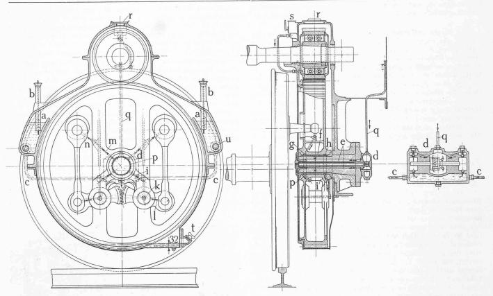
Bild 3. Buchli-Einzelachsantrieb von Brown Boveri & Cie., Baden Masstab 1:18
