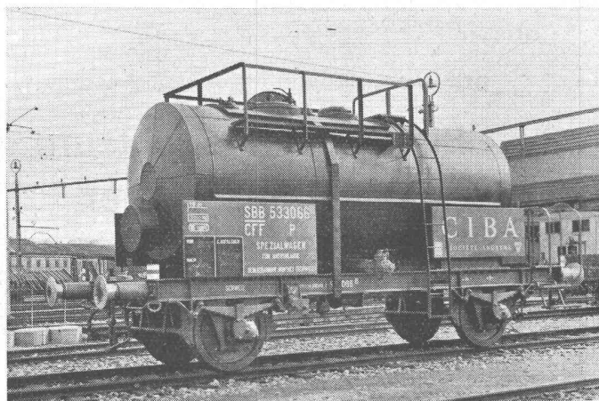
Spezial-Zisternenwagen der SBB für Chemikalien-transport, mit 70 mm Glaswolle ISOVER isoliert
