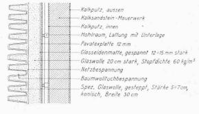
Bild 3. Wand (Ausschnitt A aus Bild 1)
