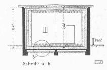
Bild 1 und 2. Schallmessraum der Albiswerk Zürich A.-G. 1:200
