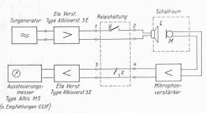
Bild 13. Prinzip der Messchaltung für die Nachhallmessung
