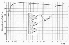
Bild 12. Absorptionskoeffizient  $\alpha$  in Abhängigkeit der Frequenz f
