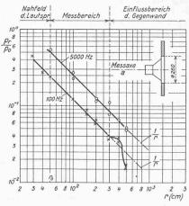
Bild 10. Schalldruckverlauf längs Axe a bei 100 Hz und bei 5000 Hz
