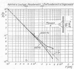
Bild 9. Schalldruckverlauf längs Axe a bei 100 Hz und bei 5000 Hz, Festlegen des Messbereiches des Raumes
