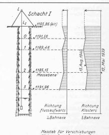
Bild 12. Ergebnisse der Lotmessungen in Schacht I
