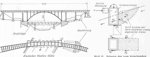
Bild 15. Schema der vom kriechenden Untergrund auf seitlich abgestützten Fundamentkörper ausgeübten Kräfte
