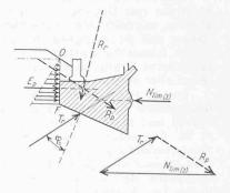
Bild 20. Stabilitätsuntersuchung für das rechte Widerlager unter Annahme von Fliessvorgängen mit passivem Erddruck (Schema)
