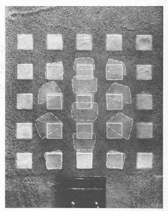
Bild 18. Stauchwirkung im Sandkörper infolge Verschiebung einer eintauchenden Platte (Photo E. Brügger)
