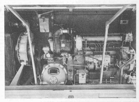
Bild 2. Dieselmotor mit Aufladegebläse, gesehen von hinten
