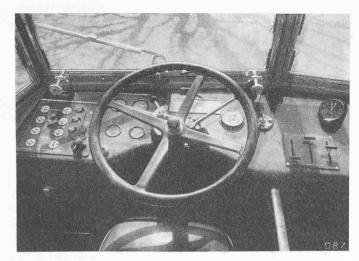
Bild 4. Führersitz mit Instrumententisch. Links des Handrades Schalter für Beleuchtung usw., rechts des Rades Schalter für Türbetätigung
