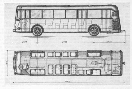
Bild 1. Berner Omnibus mit Diesel-mechanischem Antrieb. Typenskizze 1:100
