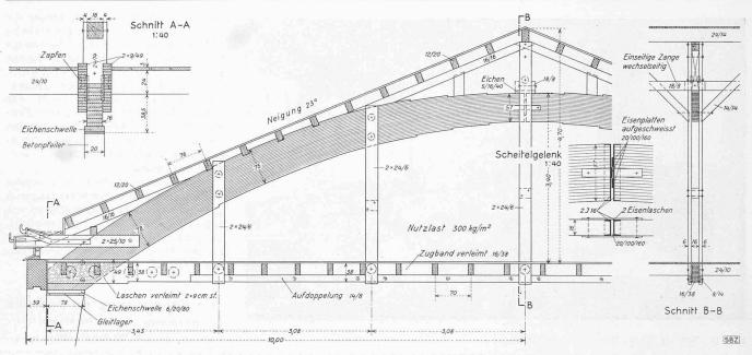
Bild 15. Dachkonstruktion mit hölzernem Bogenbinder mit Gleitlager, Masstab 1:80. — Links Haken für Hängegerüst
