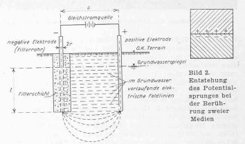
Bild 1. Schema eines elektrosmotisch betriebenen Filterbrunnens
